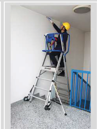
Se puede colocar en desnivel para trabajar con ella en escaleras sin comprometer su estabilidad
