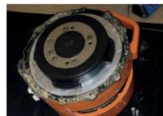
Cubierta del amortiguador removida
